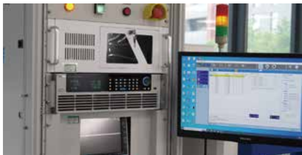
自研ATE测试系统 (JARI-ATE)
